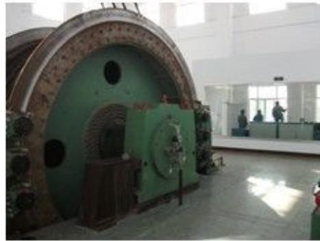
图 4 滚筒轴末端安装编码器
