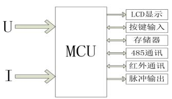
本仪表具有一路电压、电流采样输入接口,一路 RS485 通信接口,一路红外通信接口,有功功率脉冲输出接口,有一个按键输入,段码式液晶显示。
